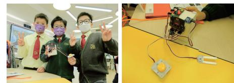
▲ 同學設計的「農業監測系統」，可以監測植物的濕度，並在 micro:bit 以「表情」顯示。
